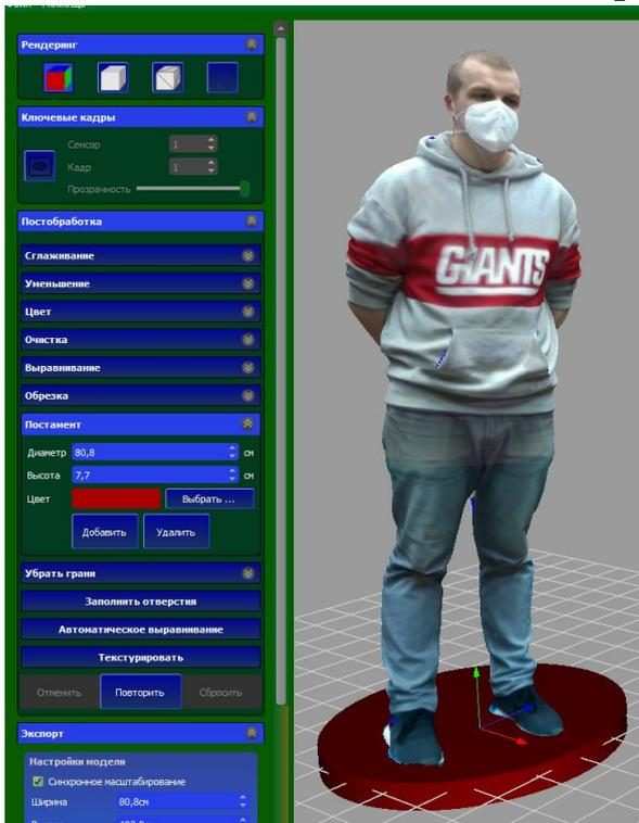
габаритного контейнера (окрашены в красный цвет), будут удалены. Для перемещения габаритного контейнера необходимо нажимать и перетаскивать манипуляторы в 3D виде. Для удаления объектов внутри габаритного контейнера включите параметр **Очистить внутри коробки**
